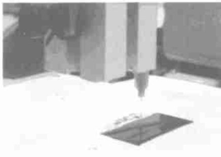
图5 机器人连续滴胶试验装置
