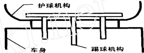
(c) 护球机构固定,有踢球机构方式
