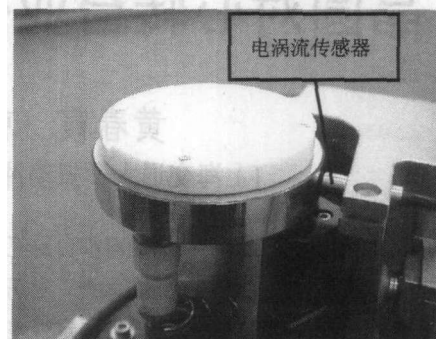
图 3 电涡流传感器测量心轴径向跳动
